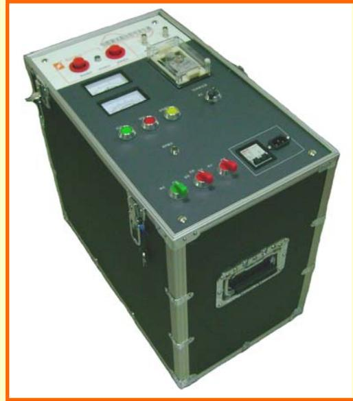
**HGD-08** 系列一体化高压脉冲发生器采用了世界上最先进的工艺和技术，在功能、性能和应用范围上都远远超过了其他同类产品，便于携带和现场使用，与华傲电缆故障测试仪\KC-900 三次脉冲电缆故障测试仪等配套使用能够对各种电缆故障进行粗测。与声磁同步定点仪等其他设备配套使用能够对各种电缆故障进行精确定点。如果选购了专用的数字式微安表，在对相匹配电压等级的电力电缆耐压试验时，还可进行泄漏电流测试。仪器内置升压整流、放电球间隙、放电装置以及高压放电电容，功能齐全，接线简单，操作安全方便。一体化设计，对被测故障电缆 2-4 秒放电一次，大大缩短故障定点时间。全新的高电压技术设计，操作简单，接线方便，并且采用安全隔离模式，对操作人员的安全提供了保障。
