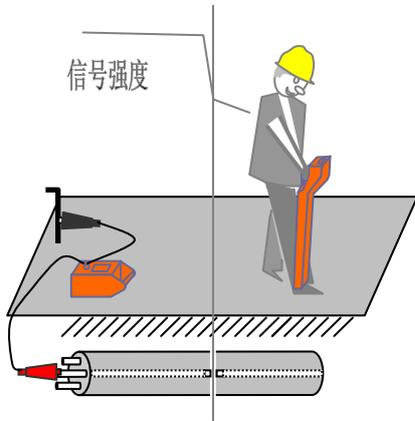
此测试方法适用于电缆的开路故障及对地泄漏的短路故障，将发射机信号加至电缆故障相，将接收机选至“波峰法”，沿电缆前行追踪，当信号有急剧减小或嘎然消失（突跳点）地段时，即可确定为故障点位置。
