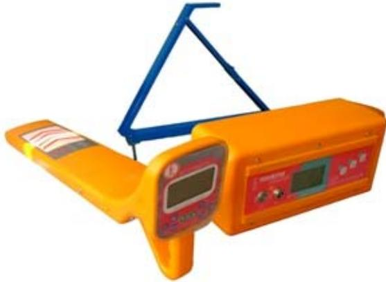
对于电力电缆的故障，常规的测试方法是向故障电缆施加高压脉冲，使故障点处放电，通过定位仪对放电处的故障定位。由于施加高压信号接线比较烦琐，并需产生几千伏至几万伏的高压，往往使操作者心理产生害怕。另外常规的测试方法需要 220V 电源，而现场往往提供不了电源。对于电缆的开路、绝缘对地短路故障，ZMY-3000 能够很好的解决了这些难题。
