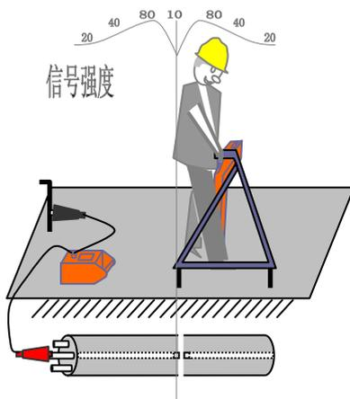
此测试方法适用于电缆的对地短路故障，由发射机对电缆施加特殊频率的高压，电压通过电缆产生的电流经电缆故障点入地，在故障点周围产生电压梯度，通过‘A’字架的两根电极沿电缆路径测量电位的变化情况。当靠近故障点时，电位差将迅速增加，并在临近故障点前达到最大值，继续前行信号出现大-小-大变化点，在这一变化中的最小点即是故障点。
